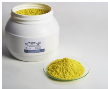
Abb. 6: Probe eines mit dem semi-industriellen Aufbau hergestellten AMP-PAN Resin
