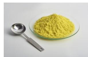
Abb. 1: Probe eines mit dem semi-industriellen Aufbau hergestellten AMP-PAN Resin
