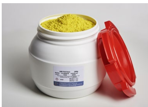
Figure 6: Echantillon de résine AMP-PAN produite avec l'unité semi-industrielle.
