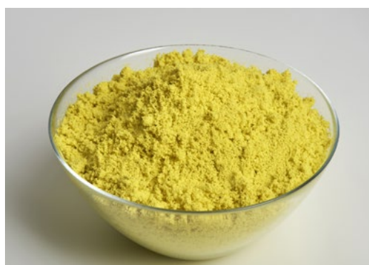
Figure 6: Echantillon de résine AMP-PAN produite avec l'unité semi-industrielle.
