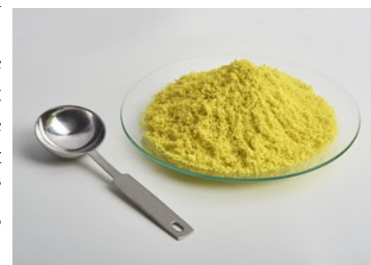
Figure 1: Echantillon de résine AMP-PAN produite avec l'unité semi-industrielle.
